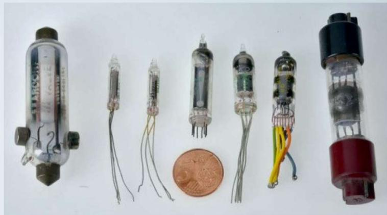
Beispiele für Miniaturröhren: Ganz links die Marconi-Osram D.E.V., dazwischen diverse 50er- und 60er-Jahre-Exemplare in verschiedenen Sockelungsvarianten, ganz rechts die Myers RAC3, eine kanadische Batterieröhre.
