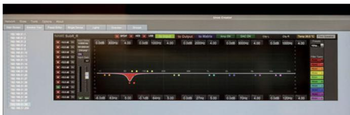
**Flexibel:** Der Frequenzgang jedes Lautsprechers kann mithilfe der AIA-Creator-Software von Ascendo einzeln auf einem Display angepasst werden.
