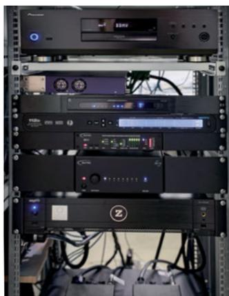
**Das Rack im Nebenraum**, von oben nach unten: Pioneer Blu-Ray-Player UDP LX800, quer stehender AVB-Switch für direkte Anbindung an Netzwerkleitungen, Packedge-Switch-Netzwerk SX-8-EP, MOTU 112D AVB, Mutec Clock MC3+, Mutec REF10 Superclock, Zappiti-Player Pro 4K HDR Audiocom Edition, Farad-Netzteile, Netzverteiler Shunyata Triton 3 (nicht mehr sichtbar).
