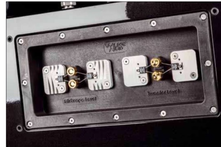
Die Widerstände dienen der Pegelanpassung im Mittelhochtonbereich
